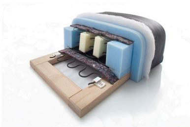
Federkernsitz aus gezogenem Federstahldraht (außer Hocker). Sitz abgedeckt mit Textilvlies, PUR-Schaum (mind. RG 35) und Wattevlies.
